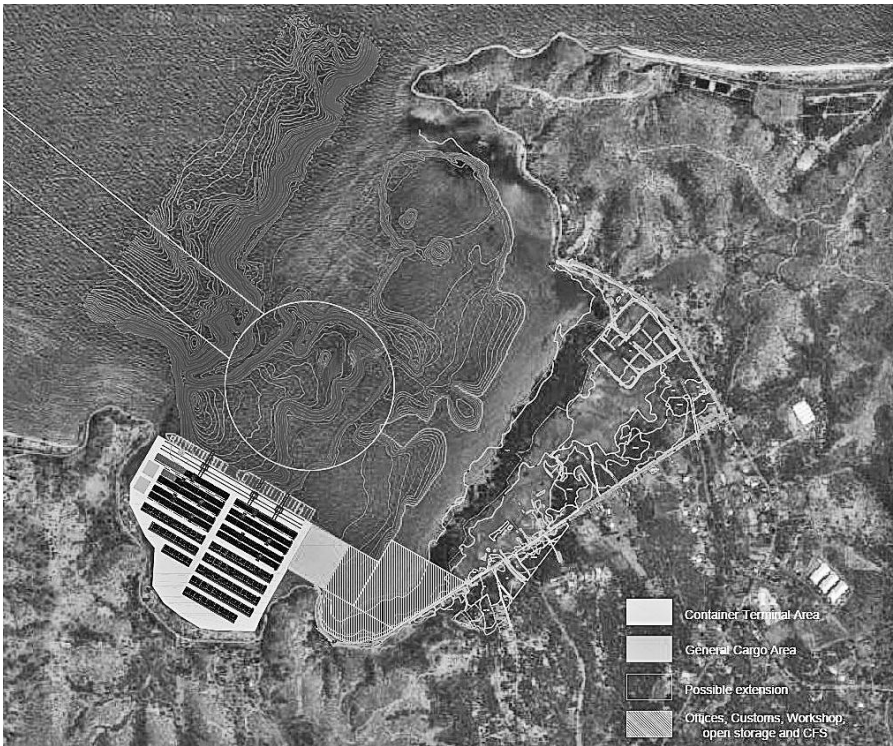
26.9 ha terminal kontentor nian, 2.7 ha fatin ba kargo jeral, 11.6 ha fatin ba edifiso, ofisina
