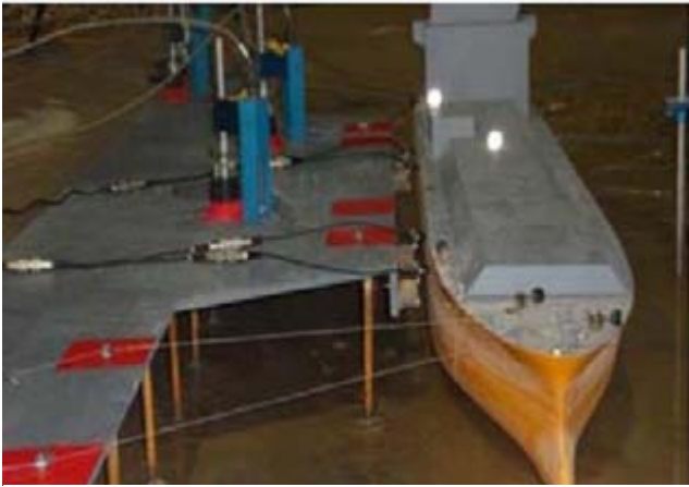
Modelo físico das instalações marítimas para o FEED a fim de testar a força das linhas de atracagem e ancoragem
